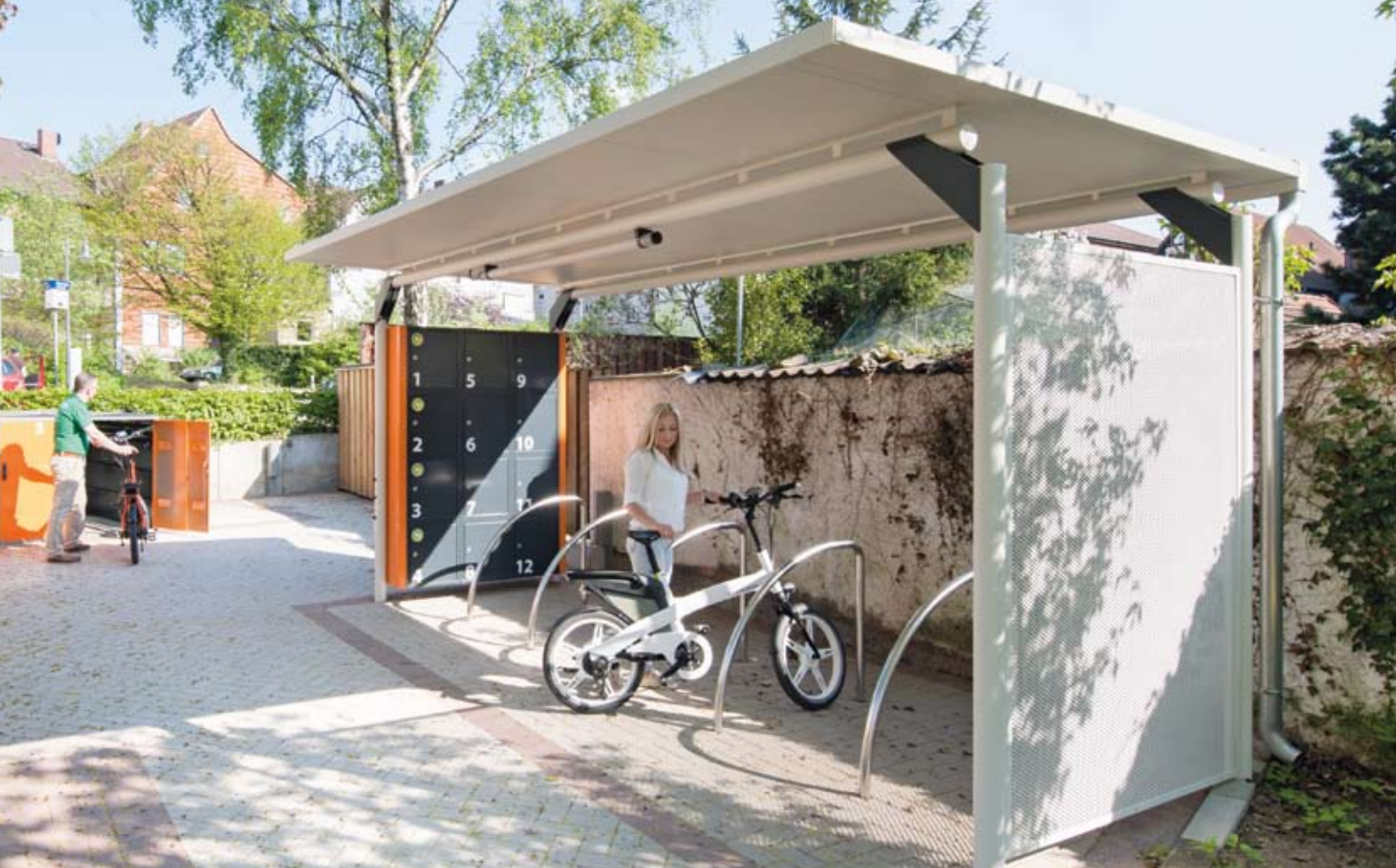
Fahrradüberdachung MATRIX, einseitig, 1 Feld, 1 Seitenwand aus Lochblech, Schließfachanlage mit 12 Fächern, Beleuchtung, Anlehnbügel SACRAMENTO, Stahlkonstruktion in RAL 9002 grauweiß, Schließfachanlage in RAL 7016 anthrazitgrau / RAL 2003 pastellgelb
