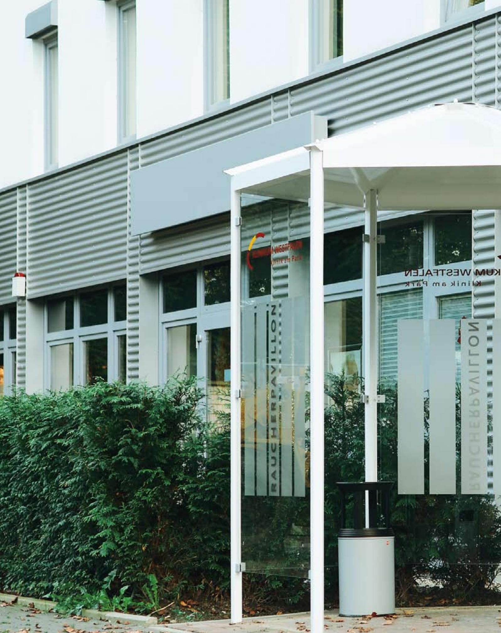
Raucherunterstand ELDORADO, mit 5 Seitenwänden, Seitenwände mit Siebdruck nach Kundenwunsch gestaltet, Stahlkonstruktion in RAL 906 weißaluminium
